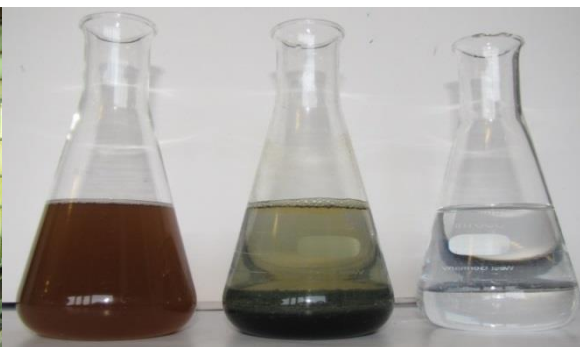
Figuur 14: Laboproef werking Sentinel® (links: restvloeistof, midden: bezinking vlokken na toedienen chemicaliën, rechts: gezuiverde water na actief koolfilter).
