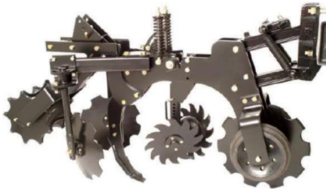
Figuur 1: Een strip-till-element bestaande uit een voorsnijschijf, gewasruimers, een tand geflankeerd door twee schijven en een rol voor verkruiemeling/aandrukken.
