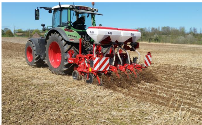
Figuur 18: de verkruiemeling en aandrukking van de bewerkte strook gebeurt door de rollen op het uiteinde van het element.
