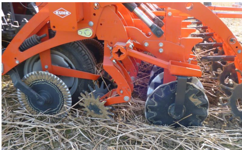
Figuur 17: stervormige gewasruimers duwen de gesneden restanten van groenbedekkers aan de kant voor de tand passeert.
