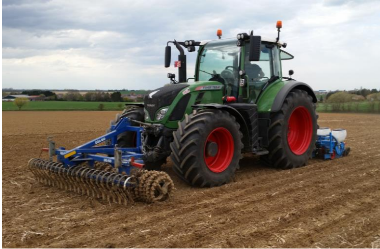
Figuur 19: om de kwaliteit van het zaaibed te verbeteren, kan een extra machine vooraan de zaaicombinatie bevestigd worden.
