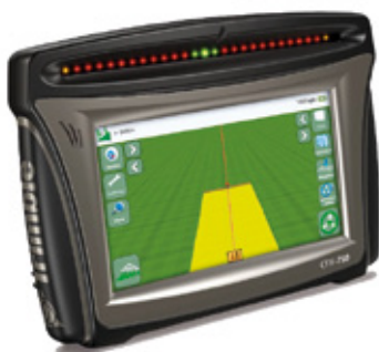
Afbeelding 3. Stuurgeleiding, met bovenaan de lichtbalk en onderaan het geleidingspatroon : een rechte AB lijn. Op het scherm is te zien dat de machine 1,23 afwijkt van werkgang R11. (Trimble CFX-750)
