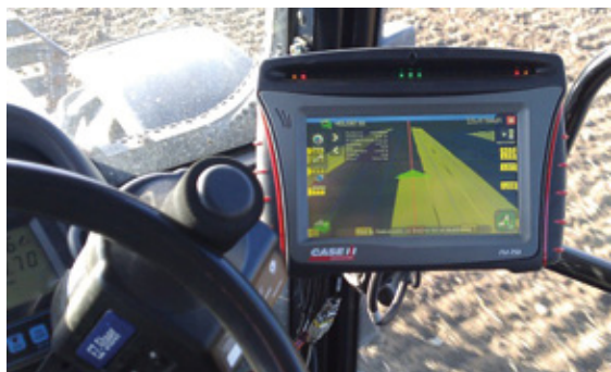
Afbeelding 4. Automatisch sturen met een elektrisch stuur. (Trimble EZ Pilot met FmX scherm)
