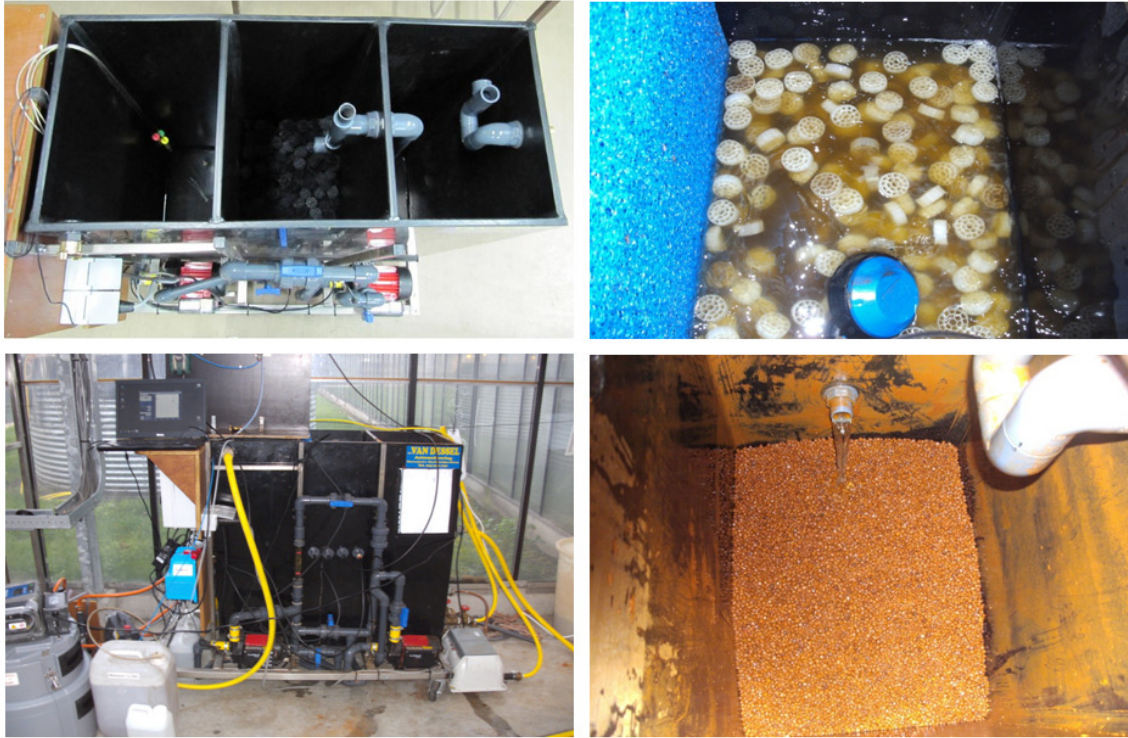
Figuur 9: Pilotinstallatie van denitrificatie- en fosfaatfilter
