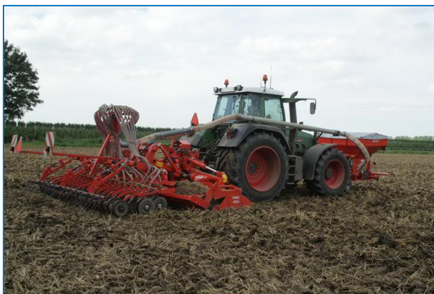
Afbeelding 50 Inzaaien met een pneumatische zaaimachine gecombineerd met een rotoreg
