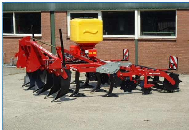
Afbeelding 51 Met een strooiunit op de grondbreker is het mogelijk in één werkgang de bodem los te maken en een groenbedekker in te zaaien
