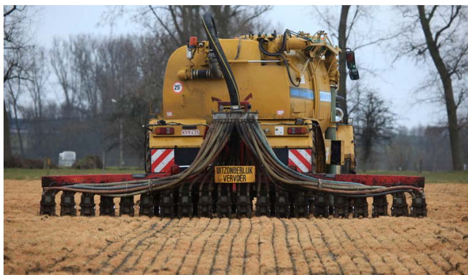
Afbeelding 1 Drijfmestinjectie op akkerland
