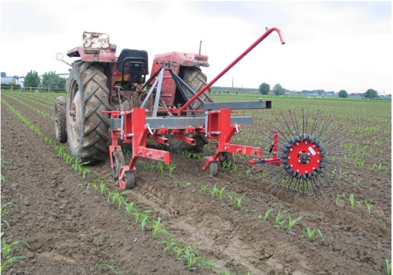
Afbeelding 25 Mechanische onkruidbestrijding bij maïs (Bron: beleidsdomein Landbouw en Visserij)
