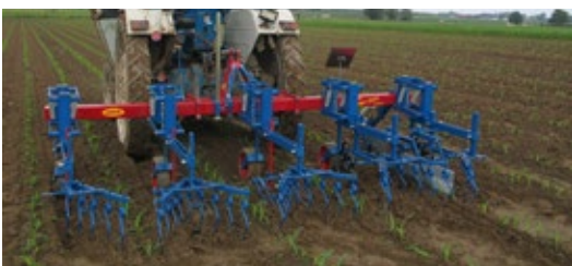
Afbeelding 24 Mechanische onkruidbestrijding bij maïs (Bron: beleidsdomein Landbouw en Visserij)
