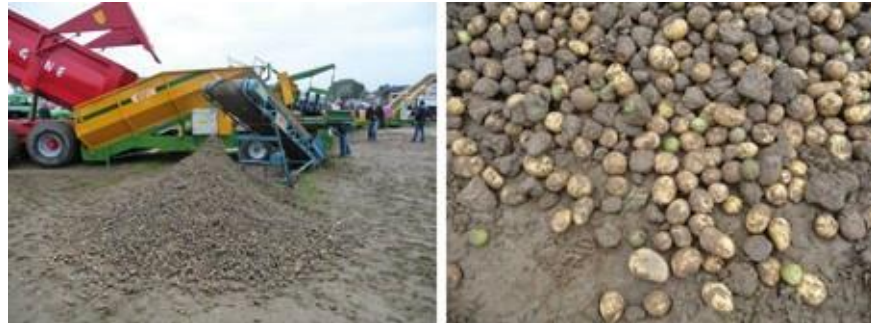
Figuur 7. Links: transport van de geogste aardappels vanuit kipwagen over rollenzeef via transportband naar vrachtwagen voor transport naar opslagloods - rechts: detailbeeld van de fractie afgescheiden via de rollenzeef: naast aarde en stenen kan deze fractie duidelijk ook bessen en knollen bevatten
